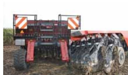
FIGURA 5: SEMINATRICE A RIGHE DI TIPO PNEUMATICO AZIENDA N. 2.
