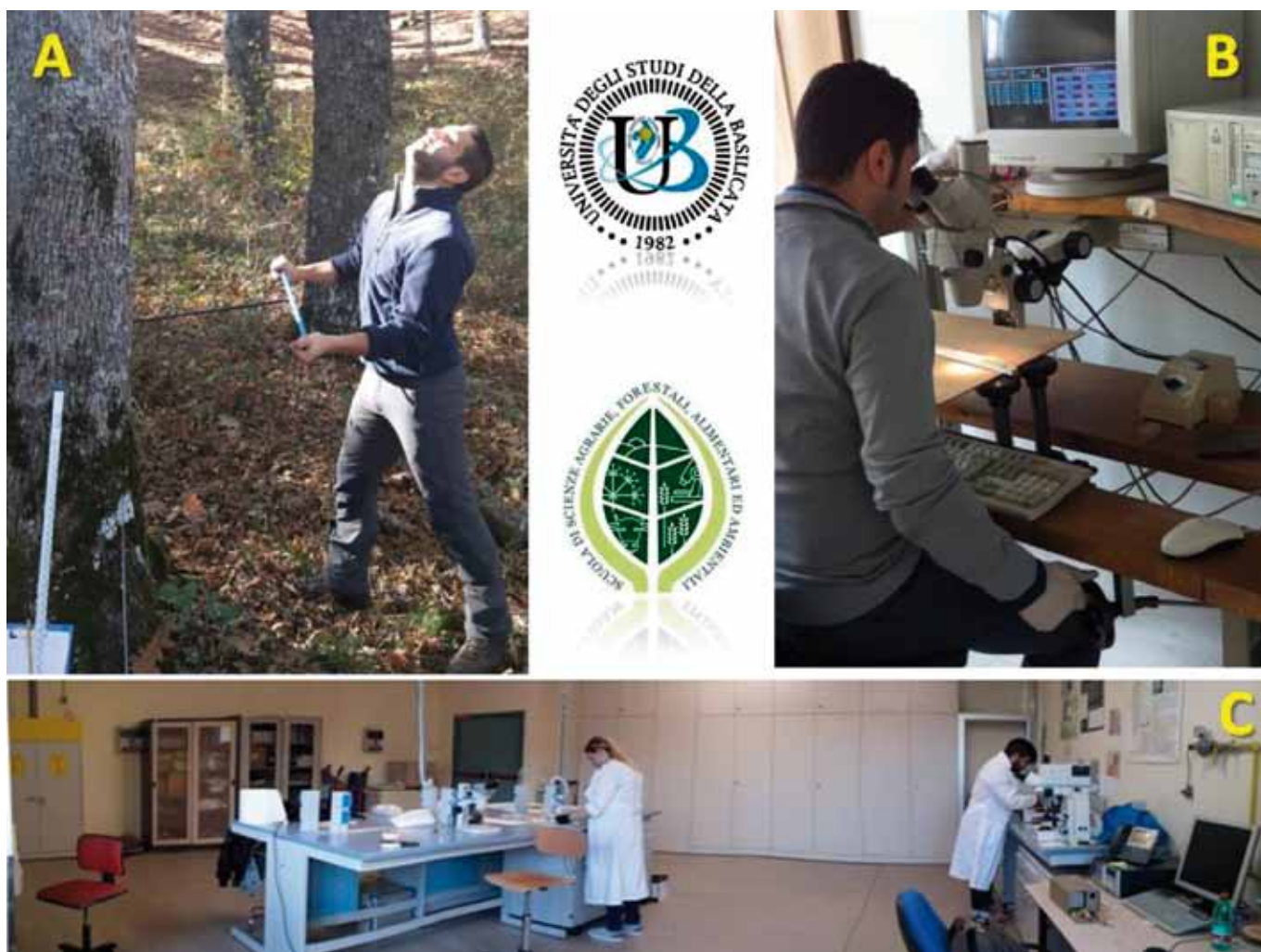
▲ Figura 3 - (A) Prelievo di carote di legno con succhiello di Pressler - (B) Misurazione degli incrementi al dendrocronografo per l'applicazione della tecnica dendrocronologica - (C) Laboratorio di Dendroecologia e Tecnologia del Legno Unibas.
